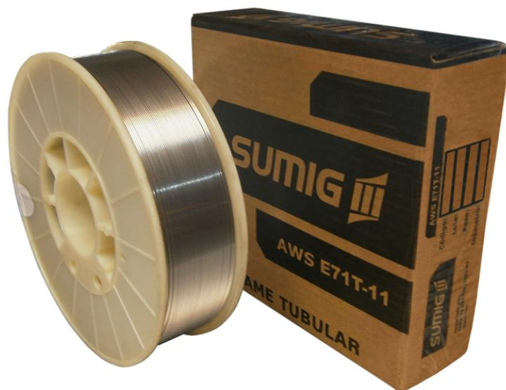
**PARA EL CORRECTO FUNCIONAMIENTO DE ESTE ALAMBRE SE DEBE CONECTAR LA TORCHA AL POLO NEGATIVO (-) Y LA PINZA DE MASA AL POLO POSITIVO (+)**
