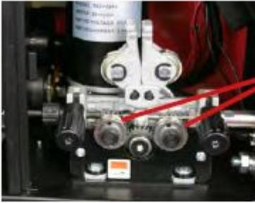
7.1.10 Coloque el rollo de alambre en el eje del carrete. Pasar el hilo por la guía de entrada y guía central hasta el tubo capilar, a través de las poleas. Después, empuje el cable unos 150 mm;
