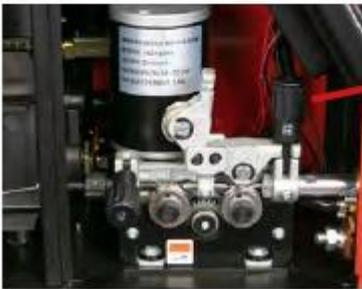
7.1.11 Cierre el soporte de rodillos superior y ajuste la presión de las poleas con relación al alambre.
