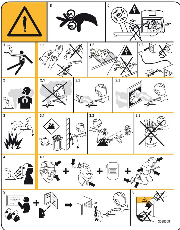
3. Las chispas provocadas por la soldadura pueden causar explosiones o incendios.
