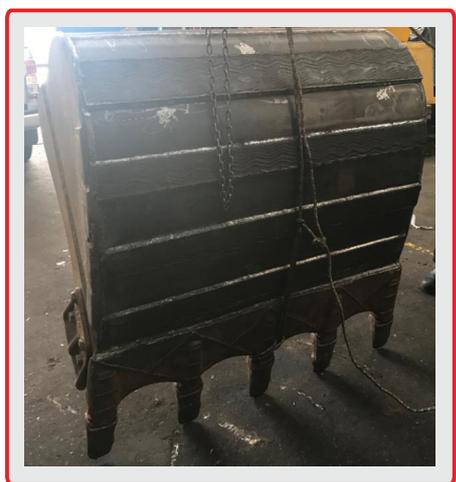
Revestimiento de cucharón para empresa *H. Petersen*. Tacho Caterpillar 320 revestido con bimetálica KST 600 de 6+4 mm. Realizado por *Diesel Motors Company S.R.L.*
