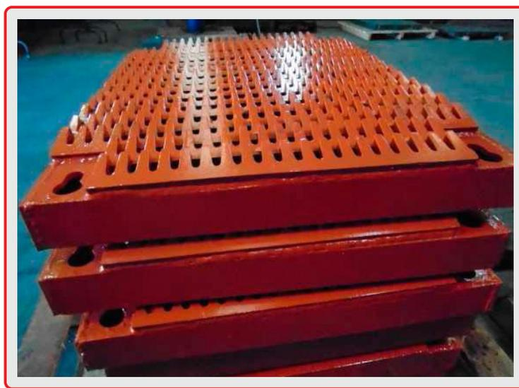
Chapa Zaranda para Sinter cortada con Water Jet
