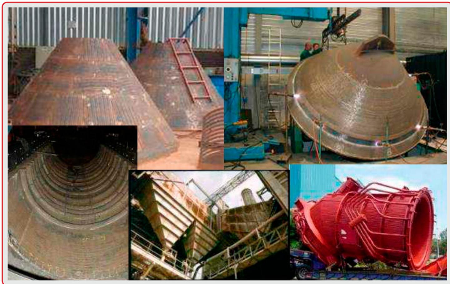
Soluciones con chapa bimetálica AGREGA para desgaste en diferentes temperaturas
