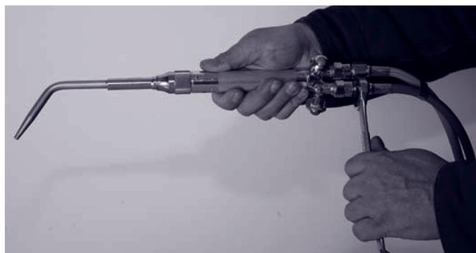
Figura 5. Acoplamiento de la manguera al soplete
