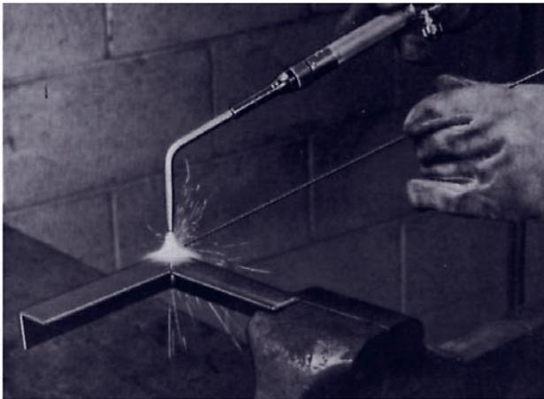
**Figura 18. Soldadura con latón**
