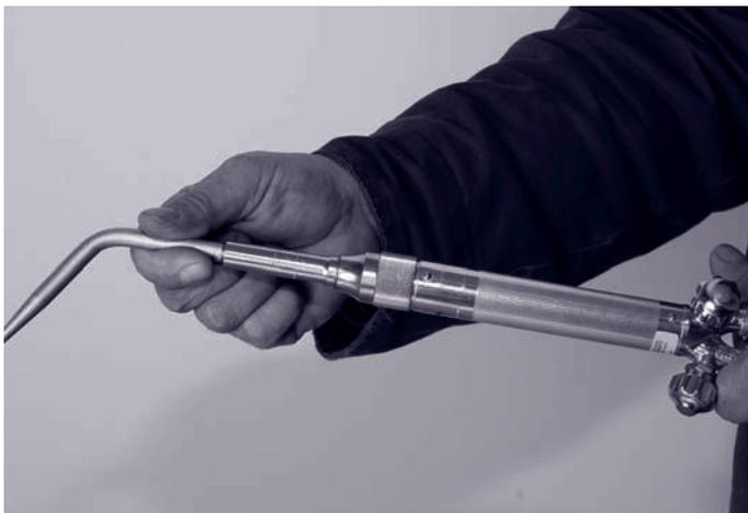
Figura 6. Instalación de la boquilla para soldar
