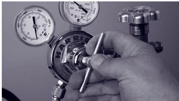
Figura 8. Llave de ajuste del regulador
