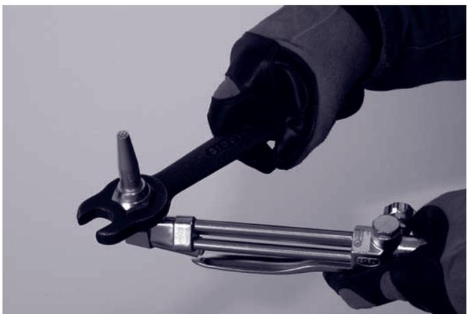
Figura 7. Instalación de la boquilla para cortar
