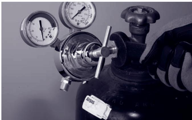
Figura 3. Acoplamiento del regulador de gas combustible
