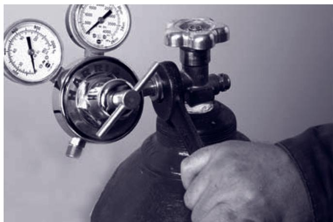
Figura 2. Acoplamiento del regulador de oxígeno
