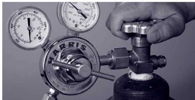
Figura 9. Apertura de la válvula de gas combustible del cilindro
