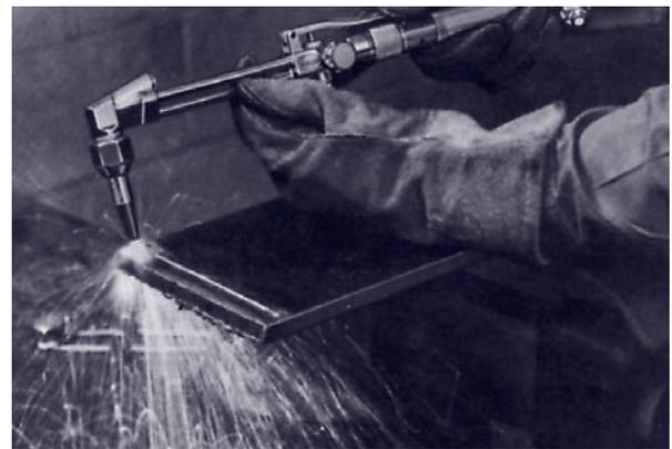
**Figura 19. Corte autógeno de acero**
