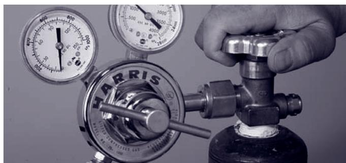
Figura 10. Apertura de la válvula de oxígeno
