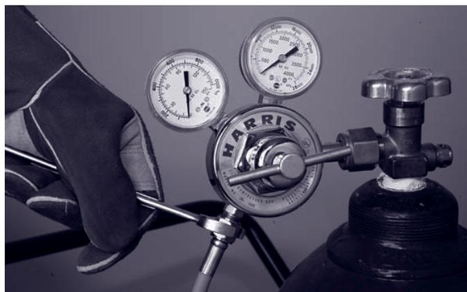
Figura 4. Acoplamiento de la manguera al regulador
