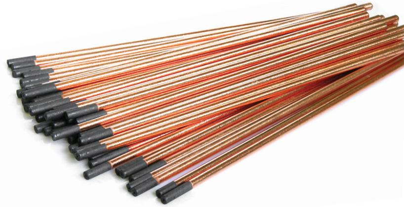
Electrodo al carbón, también conocido como electrodo de grafito, se utiliza para biselar, descarnar o cortar, proceso denominado ARCO-AIRE cuando se utiliza con una antorcha de corte.
