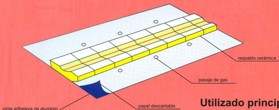
Utilizado principalmente en soldaduras más pesadas en talleres de calderería, estructuras y perfiles, con opción para su uso en láminas delgadas.
