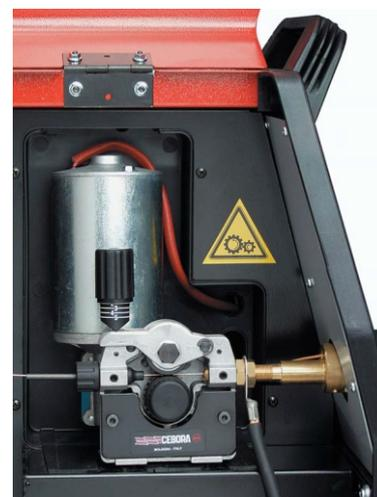
El transportador de alambre de 2 rodillos es fabricado en aluminio. La adopción del aluminio permite una mayor regularidad del avance del alambre así como un menor desgaste con el paso del tiempo.
